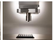
Mediante una combinación de presión negativa y ultrasonidos, las fuerzas de atracción y repulsión actúan simultáneamente sobre la pieza, manteniéndola a distancia incluso cuando se agarra desde arriba. Como resultado, no puede ocurrir contaminación o micro-rayaduras en la parte pequeña.
