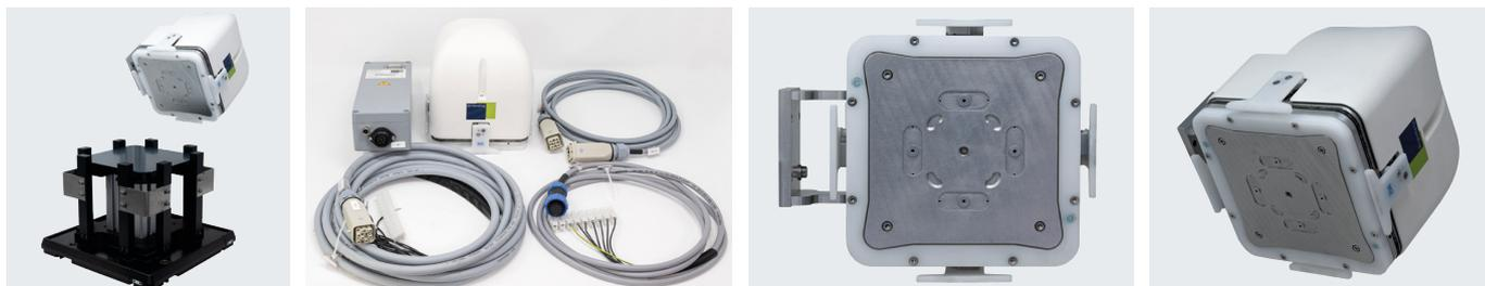
ウェーハを非接触チャックするために、超音波と負圧を併用します。負圧はウェーハを吸い寄せるとなり、超音波はチャック面にエアフィルムを形成して反発力を生み出します。そして、ウェーハと一定距離を保持します。チャック面とウェーハは非接触になり、無用な負荷を与えずにチャックすることができます。
